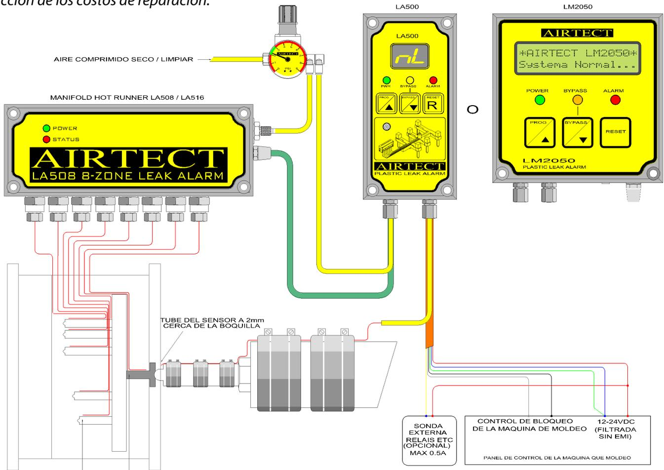
INSTALAR LOS TUBOS DE LOS SENSORES DE 2mm DE ACERO INOXIDABLE EN UBICACIONES DE FUGAS PROBABLES (ELIJA CON CUIDADO SOBRE LA BASE DE DISEÑO DE MOLDES Y / O HISTORIAL DE FUGAS)
